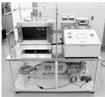
現在の反応装置。2段階反応にするため同様の装置を1台付け加える
